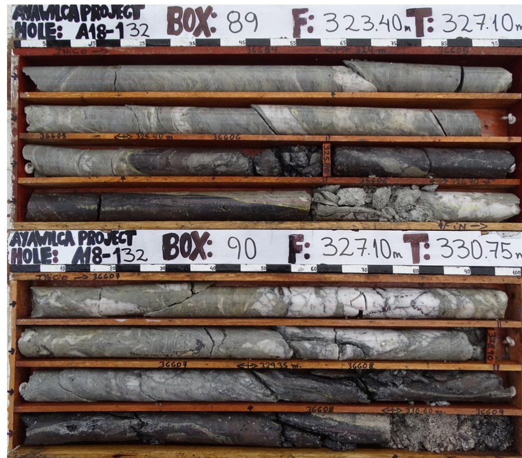
Veta alimentadora de esfalerita en filita A18-132: 7 m @ 20% Zn
