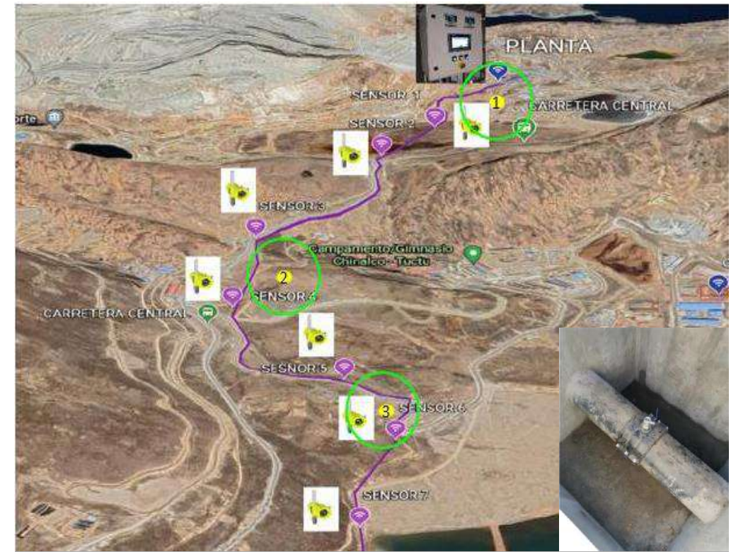
Medidor de presión - Tubería de Relaves
